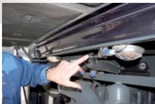
+ Beim Öffnen der Heckklappe schaltet dieser Schalter die Beleuchtung an; zugleich verhindert er, dass der Motor gestartet wird.
