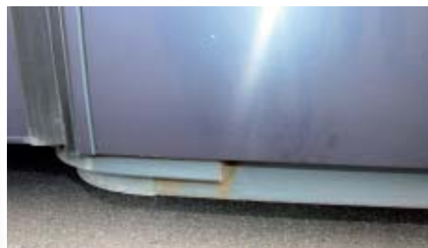
- Trotz Stainless-Gerippe: Unter der Bustoilette ist erster Rost zu erkennen.
