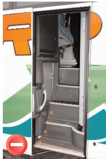
Der hintere Einstieg ist ziemlich eng; auch die Treppenstufen sind hoch.
