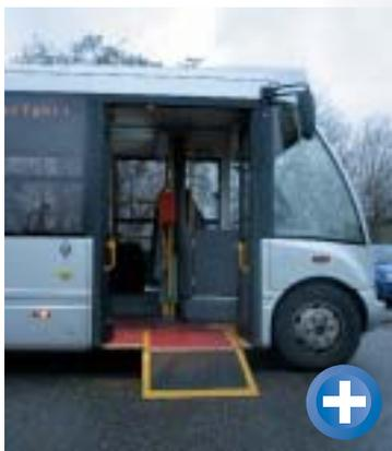
**Weil der Solo seine Vorderachse so weit vorne hat,** lässt sich der Busboden so niedrig konstruieren, dass ein fast ebenerdiges Einsteigen auch ohne Kneeling an geeigneten Haltestellen möglich ist.
