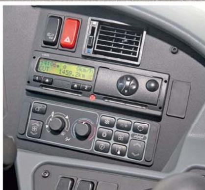
+ Besser geht's nicht: Der digitale Tachograph sitzt benutzerfreundlich noch über der Klimasteuerung in der Konsole. Weiter oben der gut erreichbare Taster für die Haltestellen-Bremse, die sich beim Gasgeben automatisch löst.
