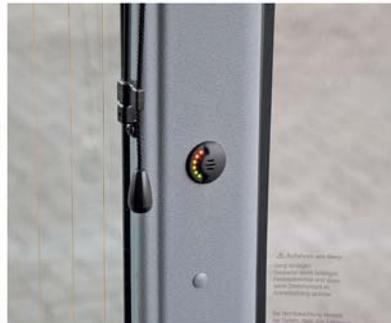
+ Trotz Miniformat gut im Blickfeld (auf der A-Säule): Abstandswarner mit farbigen Leuchtdioden und Piepsignal als Hilfe beim Zurücksetzen.
