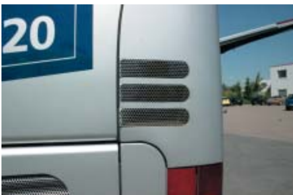
- Am Gitter für die Luftansaugung des Motors haben sich Roststellen gebildet.
