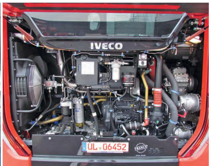
Aufgeräumter Motorraum: Die meisten Nebenaggregate und Wartungspunkte des quer eingebauten „Cursor 9“ sind gut erreichbar. Hilfreich sind LED-Rücklichter und Positionsluchten.
