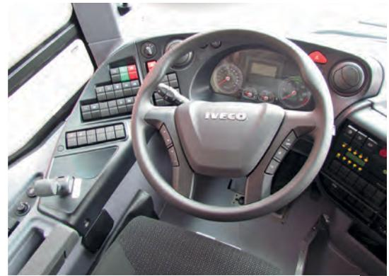
Standard Fahrerplatz nach EBFS-Richtlinie (European Bus System of the Future): links die Parkbremse sowie weitgehend bekannte Schalter im Lenkrad und am Lenkstockhebel.
