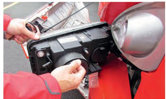
Einfach zu wechseln: Die Lampen für das Fahrlicht sind die einzigen, die noch nicht in LED-Technik ausgeführt sind.
