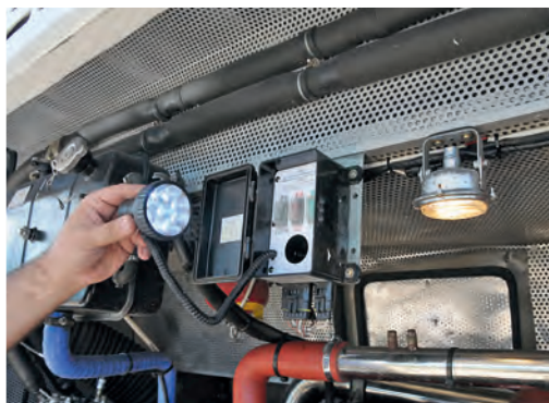
+ Zwei Lampen erleichtern die Arbeit im Motorraum. An der Trennwand zum Fahrgastraum kann man eine intensive Isolierung sehen.
