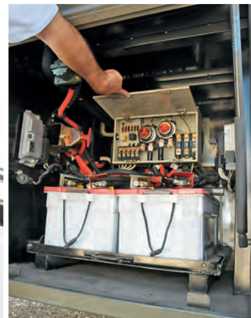
+ Ordentlich: Batteriebank mit Schaltkästen für die Elektronik des Unterbaus
