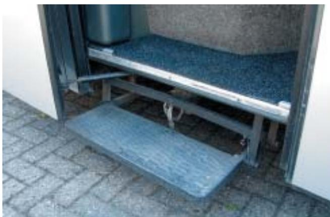
**+ Mitgedacht:** Eine weitere Trittstufe, die elektrisch ausfährt, erleichtert das Ein- und Aussteigen an der mittleren Tür.
