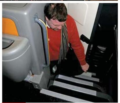
**-** Der Zugang zur tief montierten Bordtoilette wird durch die Stufen eingeschränkt und ist somit zu eng.
