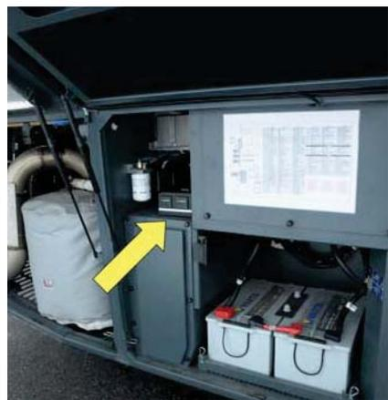
**+** Mitgedacht: Betriebsstundenzähler für Klima und Standheizung erleichtern die Abrechnung zur Erstattung der Energiesteuer.
